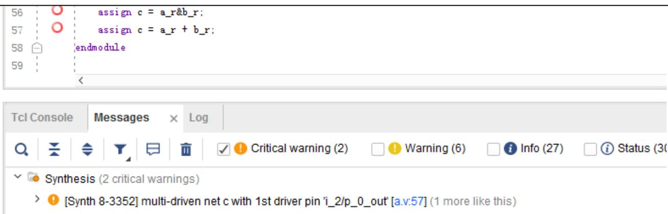
图 1-4 Vivado 中多驱动报出 Critical warning
