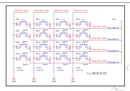
可以看到,4X4 键盘矩阵只用了 8 个引脚: FPGA\_KEY\_COL\_1~FPGA\_KEY\_COL\_4,FPGA\_KEY\_ROW\_1~FPGA\_KEY\_ROW\_4。其中列 FPGA\_KEY\_COL\*通过一个高电阻接地,行FPGA\_KEY\_ROW\*通过一个相对低的电阻接高电平。当有开关闭合时,闭合处对应的列 FPGA\_KEY\_COL\*和行FPGA\_KEY\_ROW\*有相同的电平。
